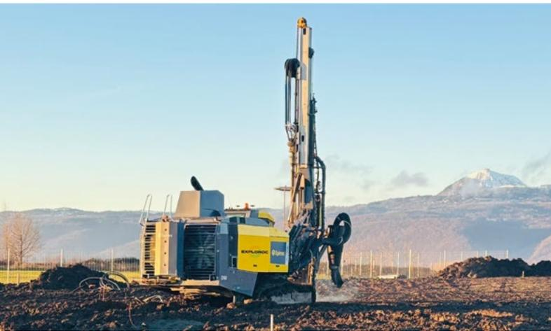
**Foreuses à marteau fond de trou exclusivement permettant de répondre à un large spectre de diamètres de 80 à 250mm, profondeurs et géologies**
